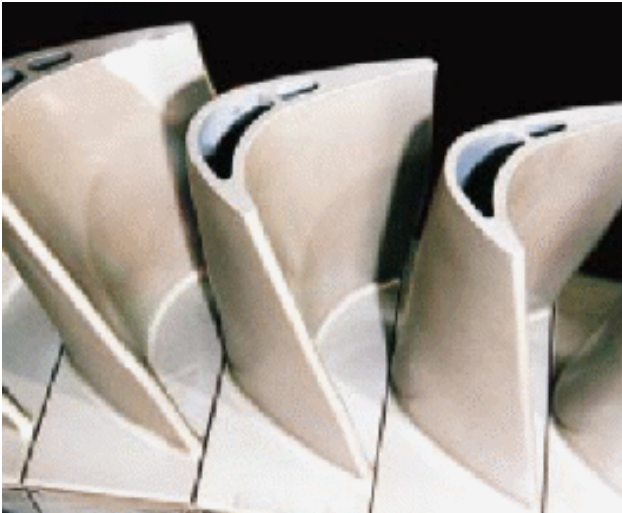
682 Lopatky spalovací turbíny řady MS5002 od GE s chladicími kanály
